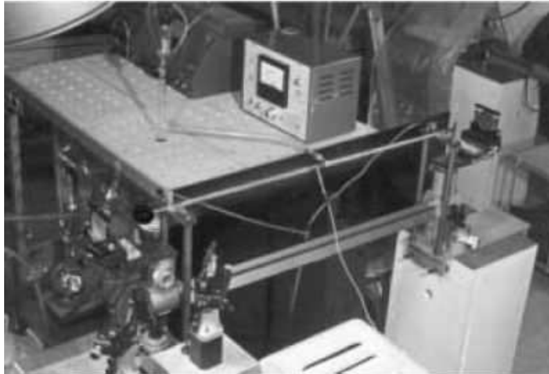
1. ábra. Az első magyar hélium-neon gázlézer fényképe. A fényerősítés az optikai padon rögzített kvarcüveg-csőben a külső elektródás nagyfrekvenciás térrel keltett kisülési plazmában jött létre. A lézerműködéshez szükséges visszacsatolást a cső két oldalán egymással pontosan szembeállított nagy reflexiójú ezüsttükörök biztosították. Háttérben a vákuum- és gáztöltő rendszer látható.
