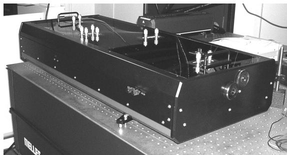
2. ábra • Az R&D Ultrafast Lasers Kft. FemtoRose 10 MCD csörpölt tükrökkel kompenzált, Kerr-lencsével módusszinkronizált Ti-zafír lézere
